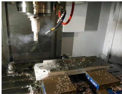
图5：安装于日本森精机NVX-5100 II机床的低温切削系统，以及零件样品。
