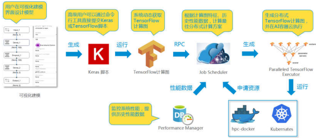
图 3 单机转换为分布式 TENSORFLOW 程序处理流程
