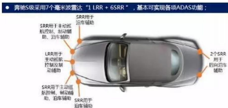
图 29：奔驰 S 级采用 7 个毫米波雷达
