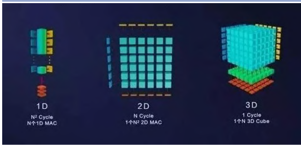
图 3：达芬奇架构的 3D Cube 技术
